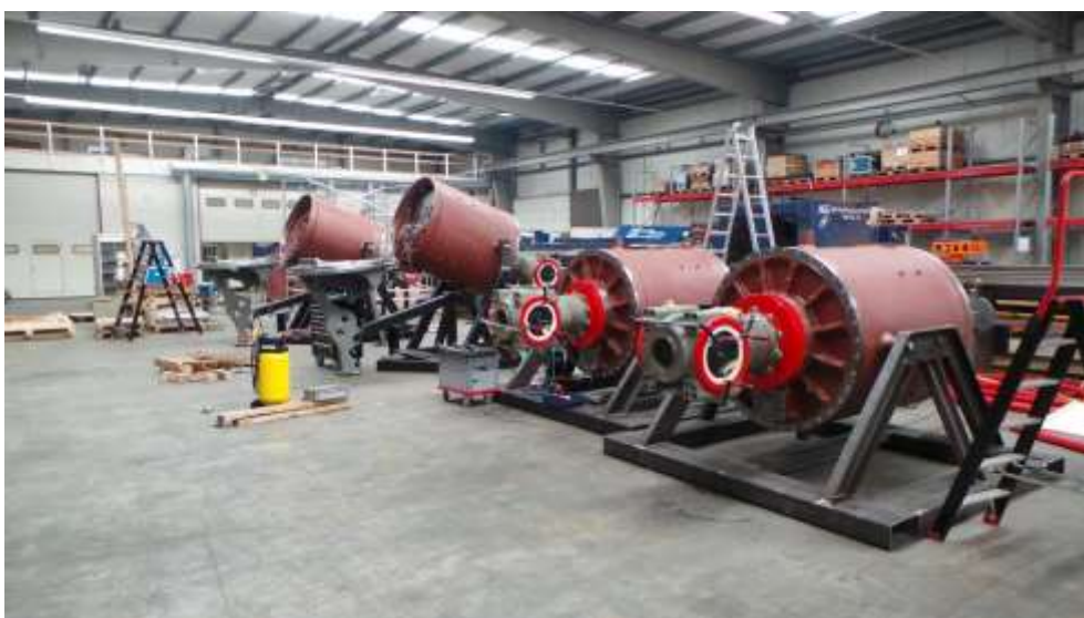
Figuur 3: Bouw van de T2 getijnturbines bij Tocardo
